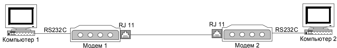
Рис.10 – Схема лабораторной установки, работа на коммутируемой линии
